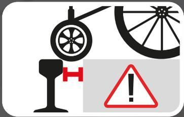
*“Atravessar a via férrea num dispositivo de mobilidade, como cadeiras de rodas elétricas ou manuais e andadores, requer cautela e atenção redobrada para evitar que as rodas ou seus apoios fiquem presos entre os trilhos e o pavimento de cobertura da passagem de nível.*
